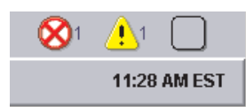
図 79. IBM Director コンソール、右下にあるハードウェア状況アイコン
