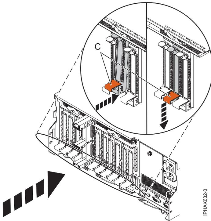
Figure 125. Installation de la cassette de cartes PCI
