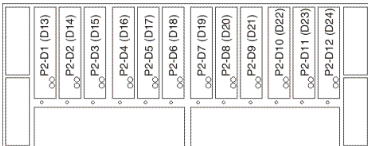
Figure 40. Vue arrière des boîtiers d'unités de disques SCSI 31D/24 et 31T/24
