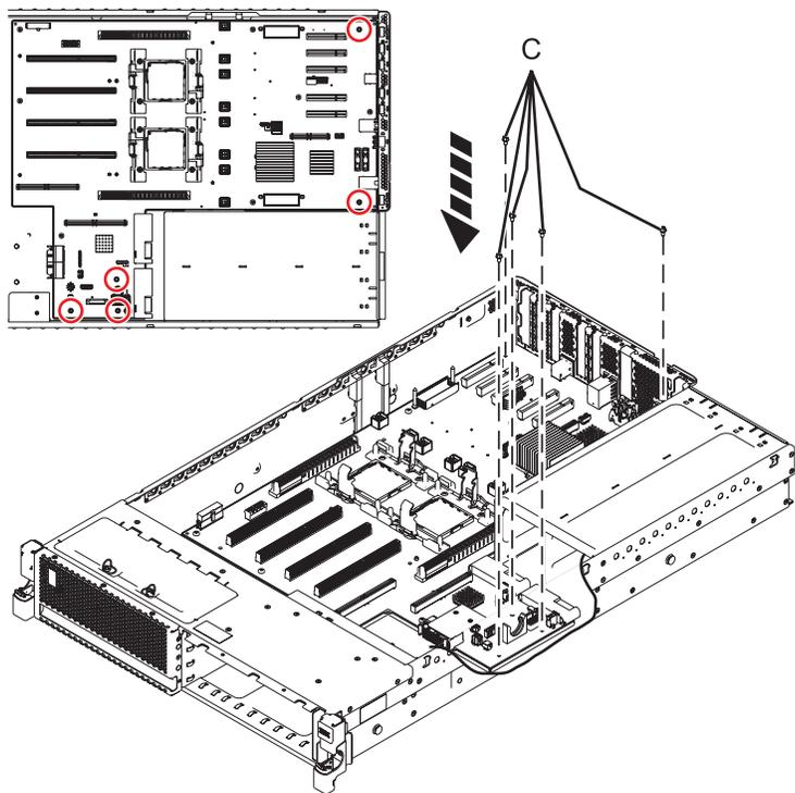
Figure 52. Remplacement du fond de panier système (cinq vis pour 31E/2B)
