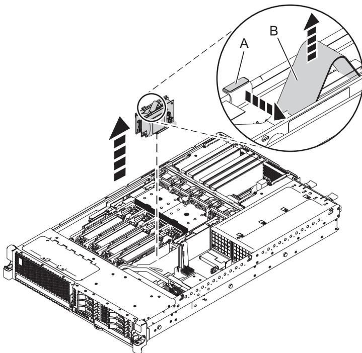
Figure 16. Retrait d'un contrôleur de stockage RAID/cache d'un système 31E/1C ou 31E/2C monté en armoire
