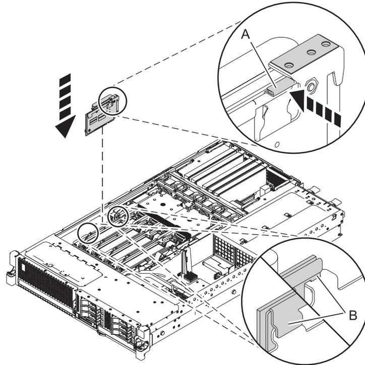
Figure 23. Installation de la carte de batterie de cache pour le système 31E/1C ou 31E/2C
