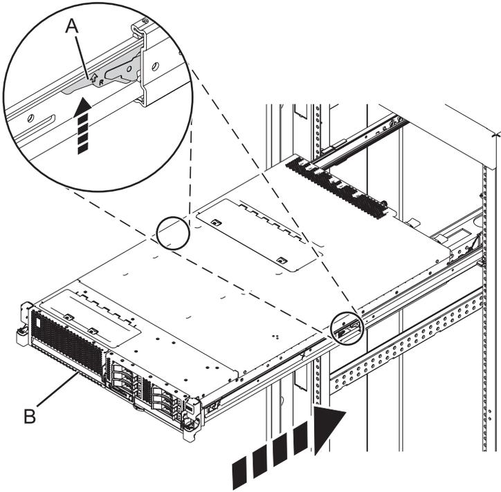
Figure 69. Déverrouillage des taquets de sécurité des glissières
