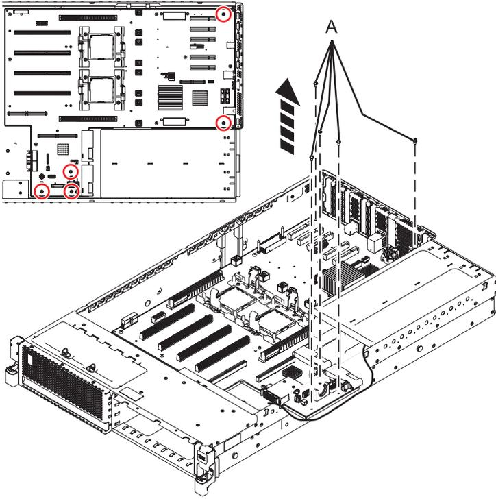
Figure 46. Retrait du fond de panier système (cinq vis pour 31E/2B)
