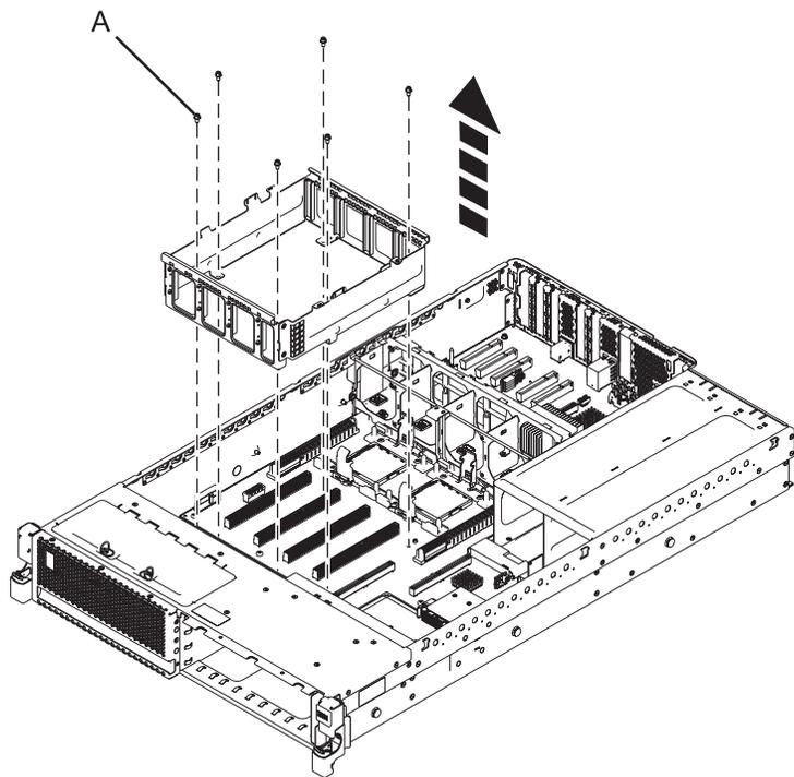
Figure 44. Retrait du boîtier de barrette DIMM
