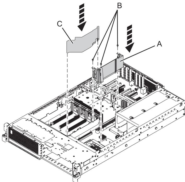
Figure 57. Remise en place du répartiteur d'air du régulateur de tension (31E/1C ou 31E/2C)
