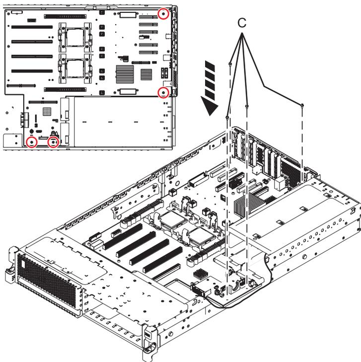
Figure 53. Remplacement du fond de panier système (quatre vis pour 31E/1C ou 31E/2C)
