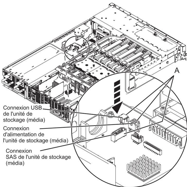
Figure 59. Connexion des câbles de l'unité de stockage
