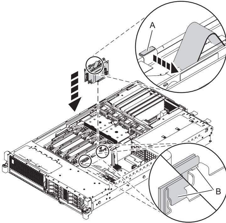
Figure 18. Remise en place d'un contrôleur de stockage RAID/cache dans un système 31E/1C ou 31E/2C
