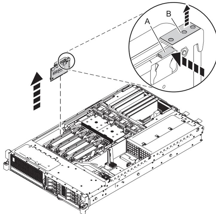
Figure 21. Retrait de la carte de batterie de cache du système 31E/1C ou 31E/2C
