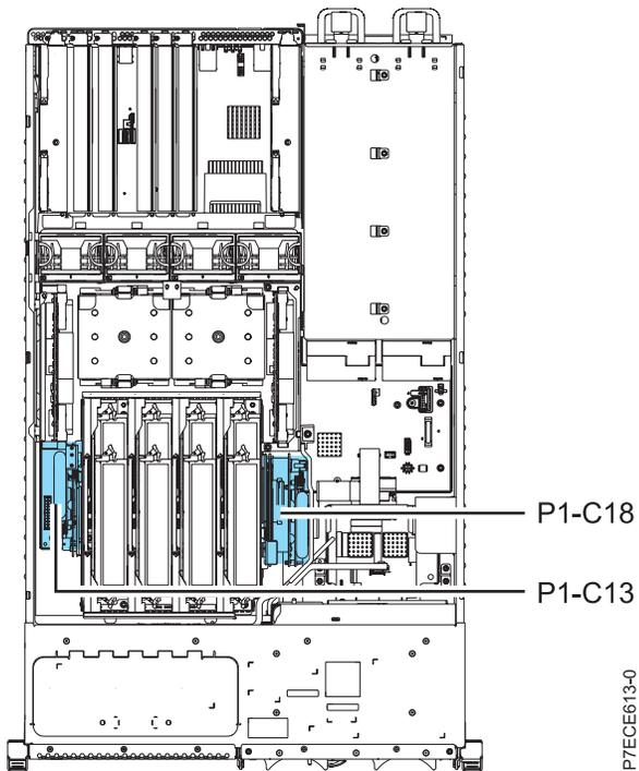
Figure 14. Emplacement d'installation du contrôleur de stockage (P1 à C18) et de la carte de batterie de cache (P1 à C13) pour 31E/1C ou 31E/2C
