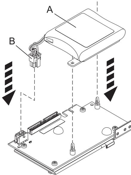
Figure 25. Remplacement de la batterie de cache
