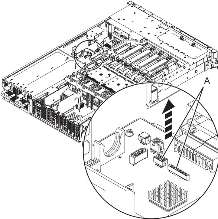
Figure 38. Débranchement du câble du panneau de commande
