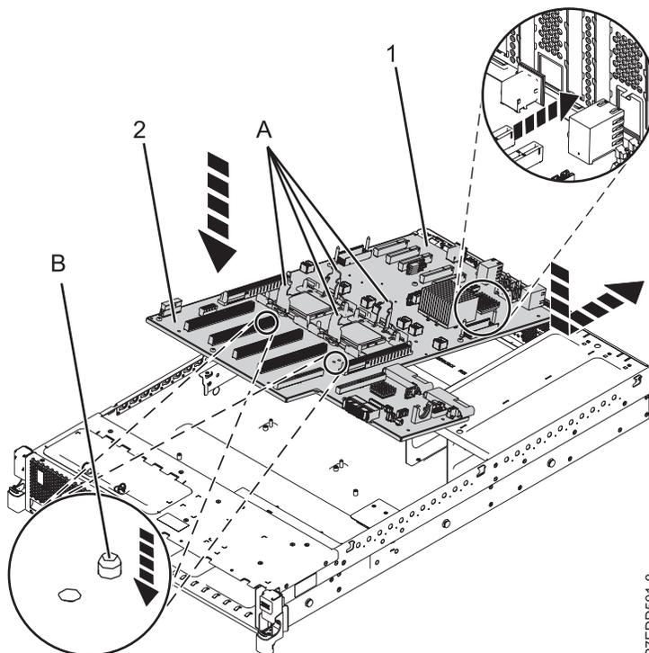
Figure 50. Remplacement du fond de panier système (31E/2B)
