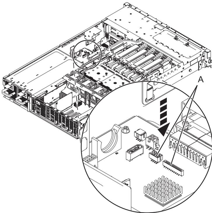
Figure 61. Connexion du câble du panneau de commande
