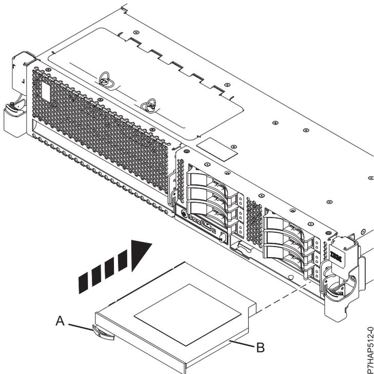
Figure 37. Installation de l'unité de stockage (média) extra-plate
