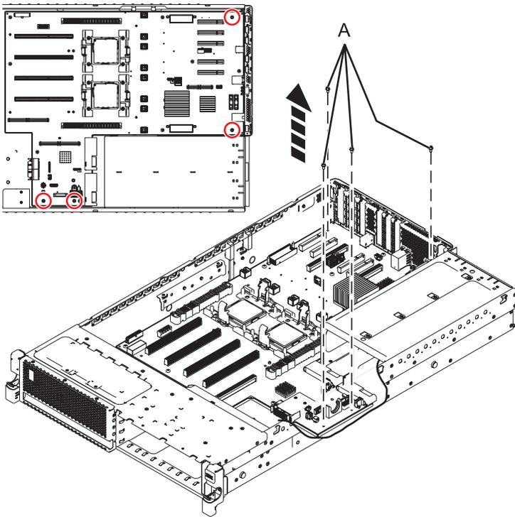
Figure 47. Retrait du fond de panier système (quatre vis pour 31E/1C ou 31E/2C)
