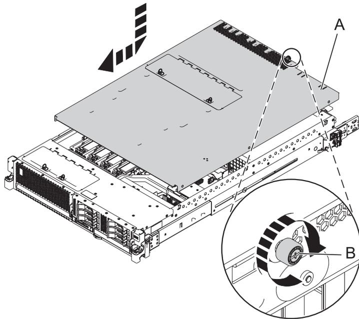
Figure 15. Installation du capot d'accès
