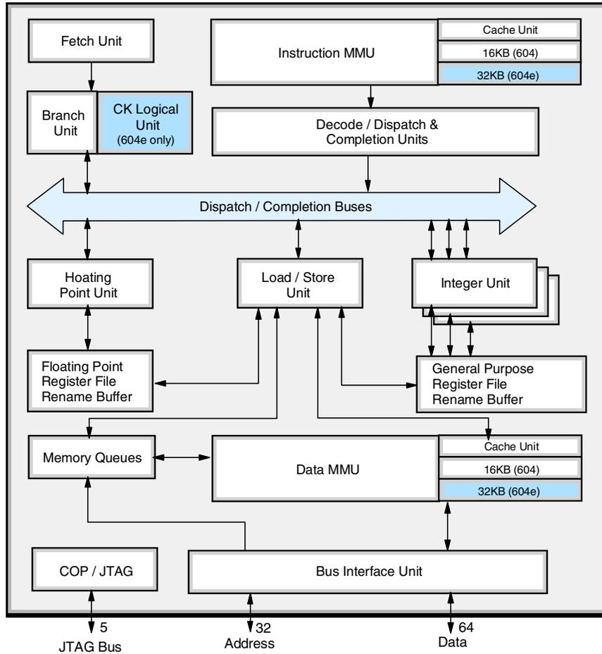
Figure 17. PowerPC 604 and PowerPC 604e Block Diagram
