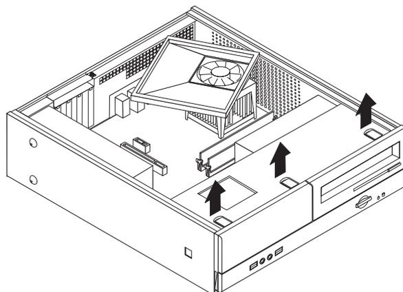
3. Отвинтите два винта в передней части рамы, крепящие отсек дисководов.
