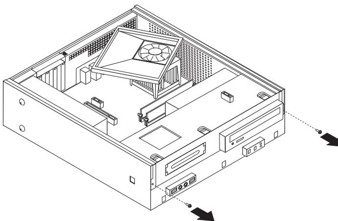
4. Сдвиньте отсек дисководов вперед так, чтобы он совместился с двумя прорезями в боковых стенках рамы и отсоедините кабели дисководов от материнской платы. После этого поверните отсек дисководов вверх и снимите его.
