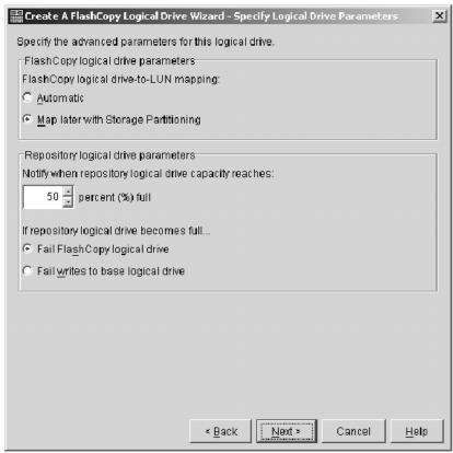
Figure 26. Specify Logical Drive Parameters
