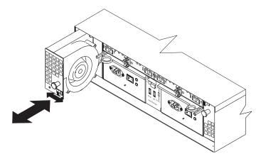
Figure 25. Replacing a fan
