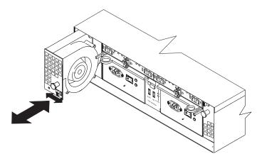
Figure 20. Removing a fan unit
