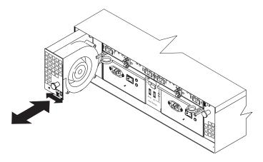
Figure 20. Replacing a fan
