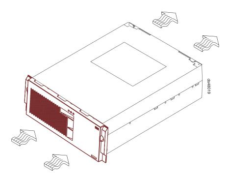
Figure 10. DS4800 Storage Subsystem airflow
