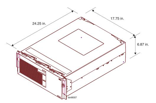
Figure 9. DS4800 Storage Subsystem dimensions
