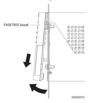
Figure 21. Removing the DS4500 Storage Server bezel
