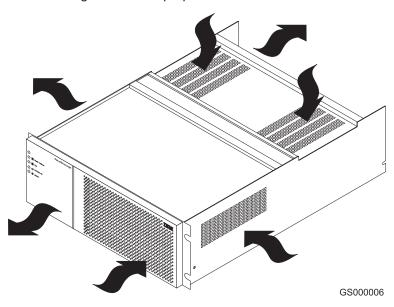
Figure 39. DS4500 Storage Server airflow
