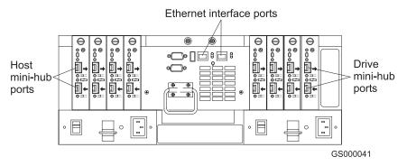
Figure 17. DS4500 Storage Server interface ports
