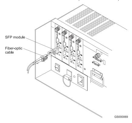
Figure 50. Installing an SFP module in a mini hub
