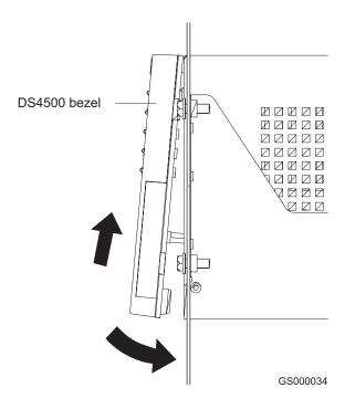
Figure 22. Replacing the DS4500 Storage Server bezel
