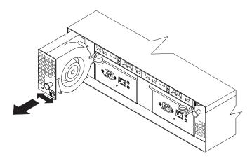
Figure 62. Removing a fan
