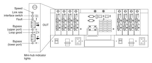
Figure 40. Type 1742 DS4500 Storage Server mini-hub indicator lights
