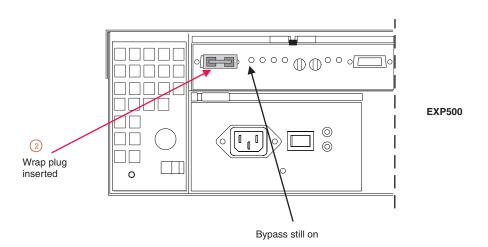
Figure 46. Insert wrap plug
