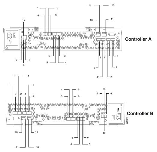
Figure 42. DS4800 RAID controller LEDs
