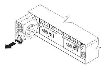
Figure 62. Removing a fan
