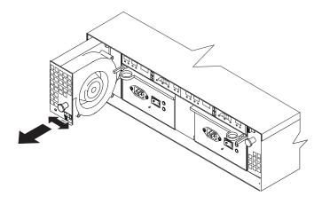
Figure 44. Removing a fan
