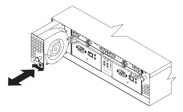
Figure 20. Replacing a fan
