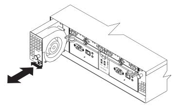
Figure 15. Removing a fan unit
