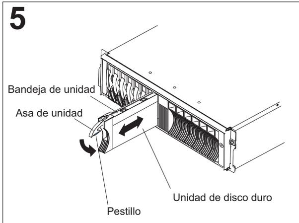
Para extraer una unidad de disco duro, presione el pestillo y tire del asa hacia arriba; a continuación, extraiga con cuidado la unidad de disco duro de la unidad de expansión.
