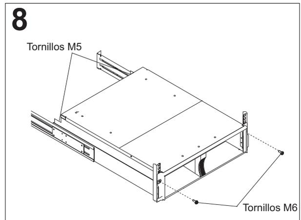
Deslice la unidad de expansión en el bastidor hasta que quede colocada en su posición; a continuación, fije la parte frontal de la unidad de expansión con dos tornillos M6.
