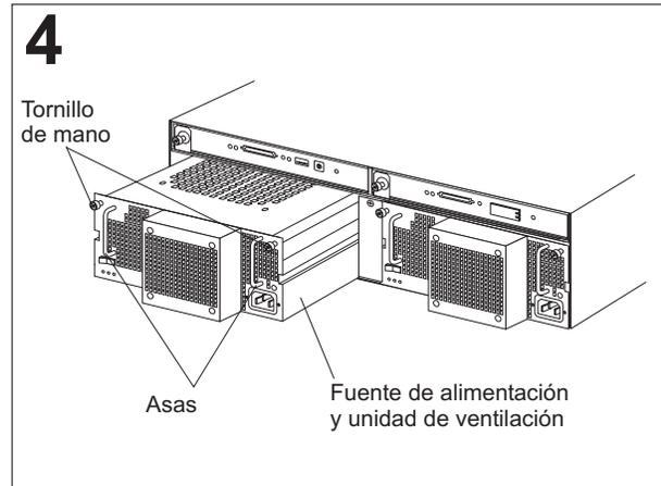
Para extraer una fuente de alimentación con unidad de ventilación, afloje los dos tornillos de mano; a continuación, sujete las asas laterales de la unidad y extráigala de la unidad de expansión.
