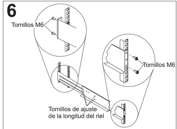
Afloje los cuatro tornillos de ajuste de la longitud del riel marcado con una **R**; a continuación, sujete la parte frontal del riel sobre la parte externa de la brida derecha frontal de montaje en bastidor y coloque dos tornillos M6 sin apretarlos demasiado.
