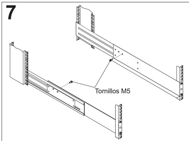
Inserte los tornillos M5 en cada riel sin apretarlos demasiado para fijar la parte posterior del chasis en el riel.
