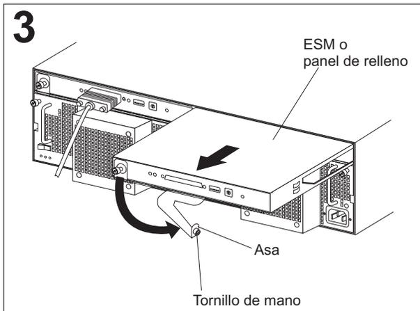
**Nota:** si elimina componentes de la unidad de expansión, reducirá el peso de la unidad y facilitará, de este modo, la instalación. En los pasos 3, 4 y 5 del procedimiento de instalación, se indica cómo extraer componentes.
