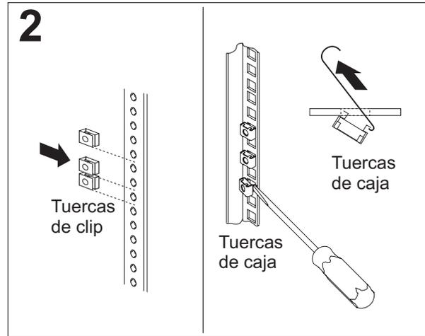
Coloque las tuercas de caja o de clip según sea necesario para el armario bastidor. Utilice un destornillador de punta plana para colocar las tuercas de caja.
