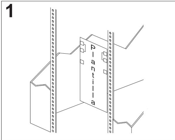
Utilice la plantilla adjunta de montaje en bastidor para localizar los orificios de las bridas frontales y posteriores de montaje en bastidor.
