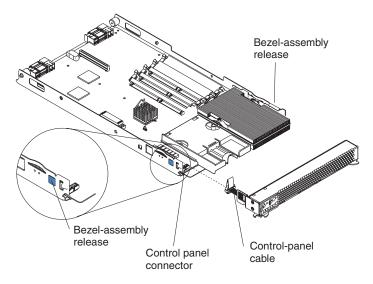
Figure 17. Blade server bezel placement
