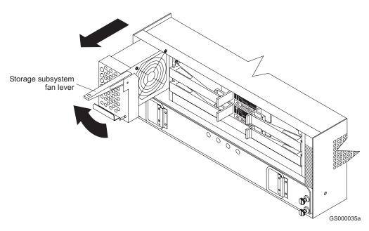
Figure 14. Storage subsystem fan removal
