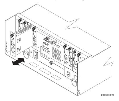
Figure 109. Removing and installing a mini hub
