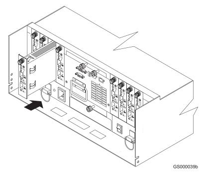
Figure 27. Replacing a mini hub
