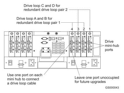
Figure 32. Drive-side mini hub ports
