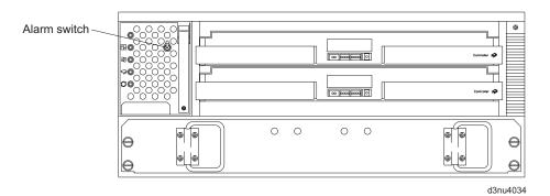
Figure 87. DS4500 Storage Subsystem alarm switch
