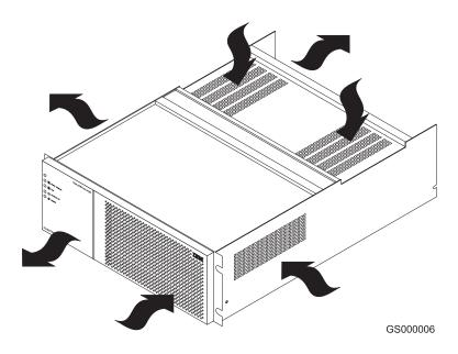
Figure 4. DS4500 Storage Subsystem airflow
