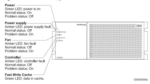
Figure 88. DS4500 Storage Subsystem front LEDs
