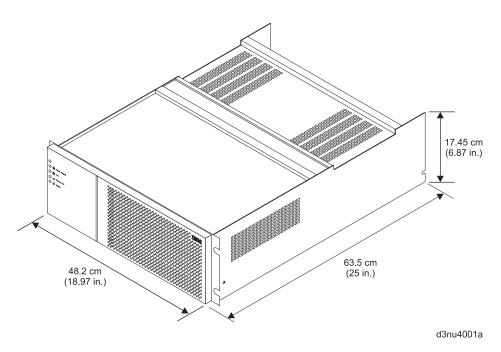
Figure 5. DS4500 Storage Subsystem dimensions
