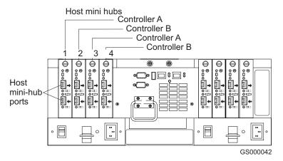
Figure 31. Host-side mini hub interface ports
