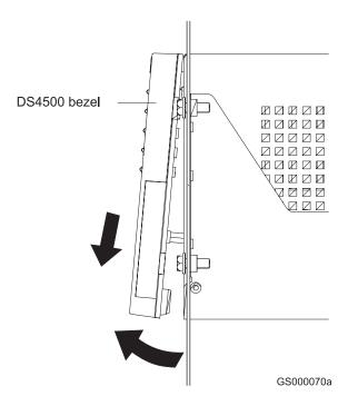
Figure 13. DS4500 Storage Subsystem bezel removal
