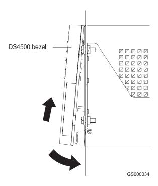
Figure 28. Replacing the front bezel
