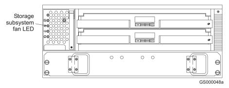
Figure 95. Storage subsystem fan LED
