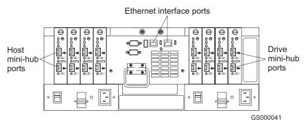
Figure 30. DS4500 Storage Subsystem interface ports
