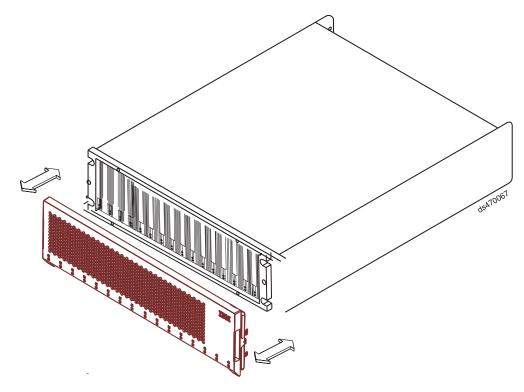
Figure 31. Installing a Telco bezel
