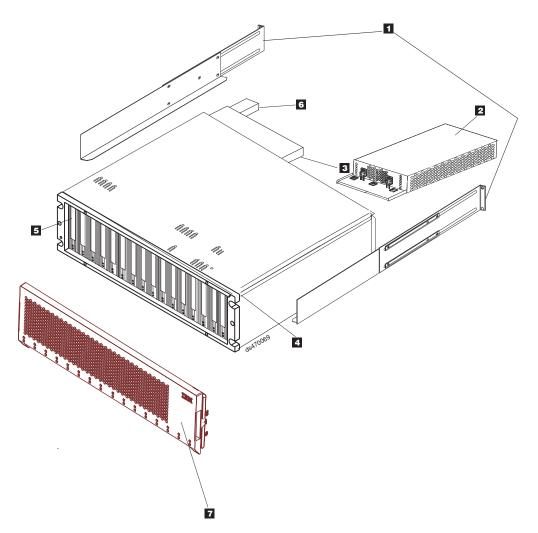
Figure 112. DS4700 Express Storage Subsystem parts list
