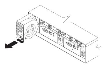
Figure 13. Replacing a fan CRU
