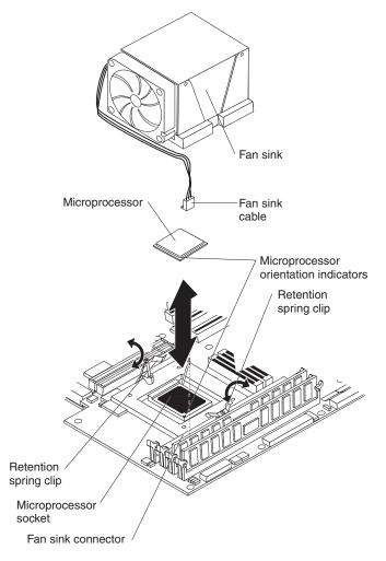
Figure 24. removing the fan sink
