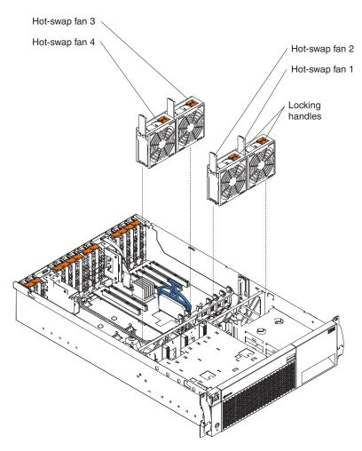
Figure 23. Replacing a hot-swap fan
