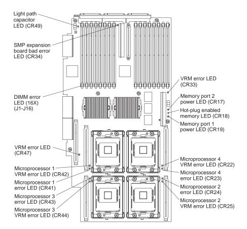
Figure 5. SMP Module LEDs
