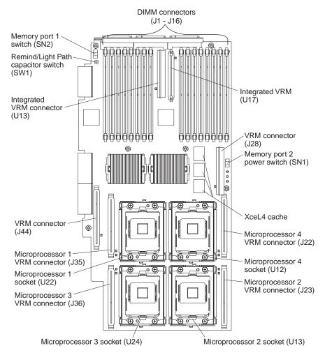
Figure 4. SMP Module connectors
