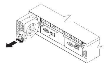
Figure 54. Removing a fan
