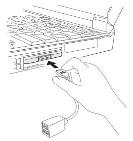
警告: 配接卡接線的接腳必須與 ThinkPad USB 2.0 CardBus Adapter 接頭正 確對齊,而且應小心地按至定位。請勿強制進行接合。強制進行接合可能會導 致 PC 卡或接線端損壞。
