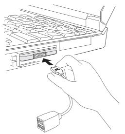
**Atenção:** O cabo da placa tem pinos para alinhamento adequado no conector da Placa ThinkPad USB 2.0 CardBus e deve ser encaixado cuidadosamente no local. Não force a conexão. Isso poderá causar danos à placa ou à extremidade do cabo.
