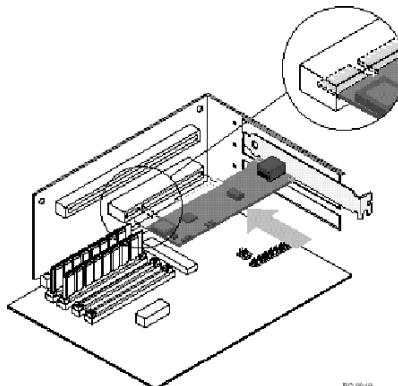
4. 依圖例，將 PCI 乙太網路配接卡插入 PCI 插槽，接著推入插槽，直到固定為止。接著使用步驟 3 卸下的螺絲固定轉接器托架。您的配接卡插槽 PCI 連接器可能和圖例中的不一樣。
