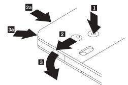
使用圆珠笔的笔尖推动并折断锁销片 1。要取出光盘,请使用圆珠笔在盒盖锁 2 上向下推并将盒盖 3 拔 出。当盒盖打开时,就可以取出光盘了。
