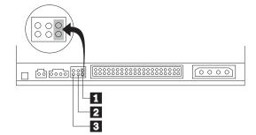
请使用以下准则来确定驱动器的正确配置。
