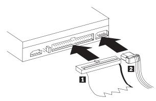
将 40 针 IDE 电缆接口 1 连接到驱动器上的 IDE 接口。对齐电缆,将着有颜色的一侧靠近电源线接口
