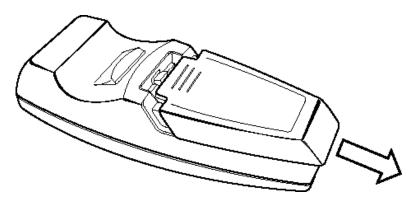
2. 将投影仪随附的电池装入遥控器电池舱中,将电池的极性(+/-)与电池舱中的极性图标对齐,如图所示。
