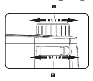
2. 使用投影仪或遥控器上的 Keystone 按钮来纠正图像梯形(顶部或底部较宽)效果。 下面显示了遥控器和投影仪上的 Keystone 按钮。
