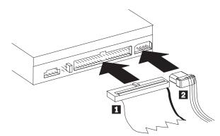
將 40 接腳的 IDE 接線接頭 1 連接至光碟機的 IDE 連接埠上。對齊接線,使彩色編碼的邊緣最靠近電 源線接頭 2 。若 IDE 連接埠上沒有連接接線,或者電腦 IDE 連接埠上只有一個裝置接頭,或者您電腦 上的現有接線為 40-conductor 低速接線,則請使用此套件隨附的 80-conductor 高速 IDE 接線。IDE 接線 最多有三個接頭。如果只有一個裝置連接至 IDE 接線,請將接頭的一端連接至 IDE 埠,將接線的另一端 連接至光碟機。請不要使用中間的接頭。
