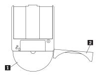
將光碟放回卡匣中,並將光碟 1 的標籤面與 DVD-RAM 卡匣的標籤面加以對齊。插入光碟並關閉卡匣機蓋 2 。機蓋門關閉時會聽到喀嚓一聲。
