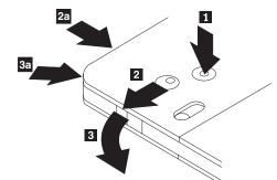
使用原子筆的筆尖推開鎖定接腳卡栓 1 。若要取出光碟,請使用原子筆將卡匣機蓋鎖 2 往下推,然後拉出 卡匣機蓋 3 。當卡匣機蓋鎖開啓時,即可取出光碟。
