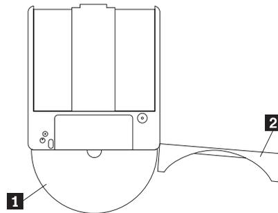
Um den Datenträger wieder in die Kassette einzulegen, richten Sie die beschriftete Seite des Datenträgers **1** an der beschrifteten Seite der DVD-RAM-Kassette aus. Legen Sie den Datenträger ein, und schließen Sie den Kassettendeckel **2**. Beim Schließen des Deckels ist ein Klicken hörbar.
