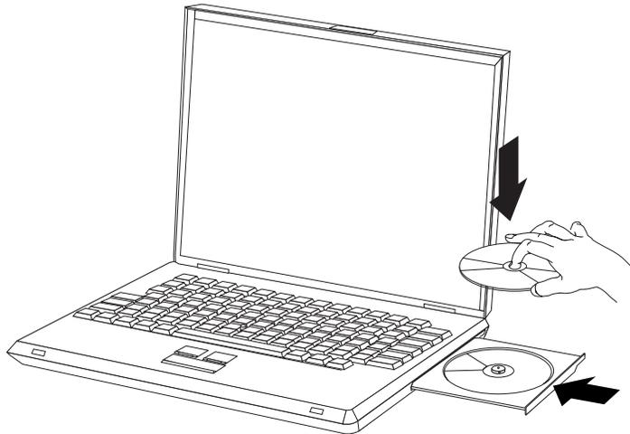
1. Drücken Sie die Entnahmetaste. Das CD-Fach wird aus dem Laufwerk herausgeschoben.
