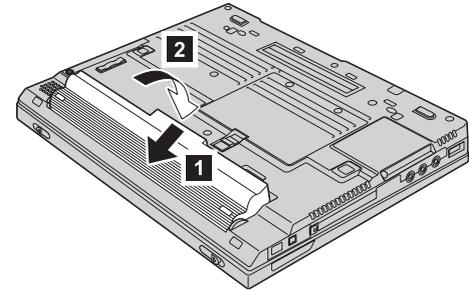
b) Faites glisser le taquet de la batterie en position de verrouillage.
