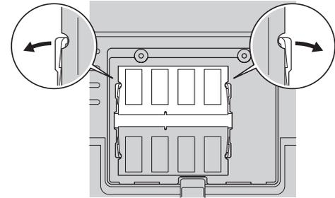
5. Localisez l'encoche située sur le côté du module SO-DIMM que vous êtes en train d'installer.
