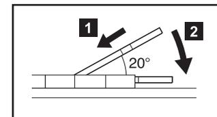
7. Faites pivoter le module vers le bas jusqu'à ce qu'il soit bien en place.
