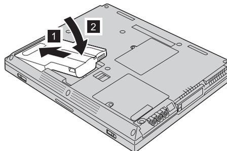
b) Faites glisser le loquet de la batterie pour le verrouiller.
