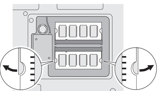
6. Con el extremo que tiene la muesca del SO-DIMM coincidiendo con la muesca del zócalo, inserte el SO-DIMM en el zócalo con un ángulo de aproximadamente 20 grados **1** ; después, presiónelo firmemente.
