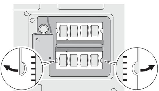
5. Localize o encaixe na borda de contato do SO-DIMM.
