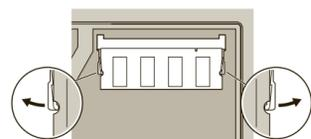
8 SO-DIMMの切り欠きをソケットに正しく合わせて、SO-DIMMを20度の角度でソケットに差し込んで1からしっかりと押し込みます 2。
