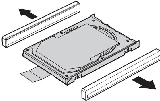
7. サイド・ラバー・レールを新しいハードディスク・ドライブに取り付けます。
