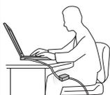
AC アダプターは、コンセントおよびコンピューターとの接続中、熱を発生します。体の一定箇所に触れたまま、AC アダプターを使用しないでください。また、AC アダプターを体を温めるために使用しないでください。人体に長時間接触したままだと、衣服を通して不快感が感じられ、低温やけどの原因ともなります。
