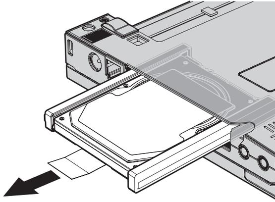
6. ハードディスク・ドライブからサイド・ラバー・レールを取り外します。
