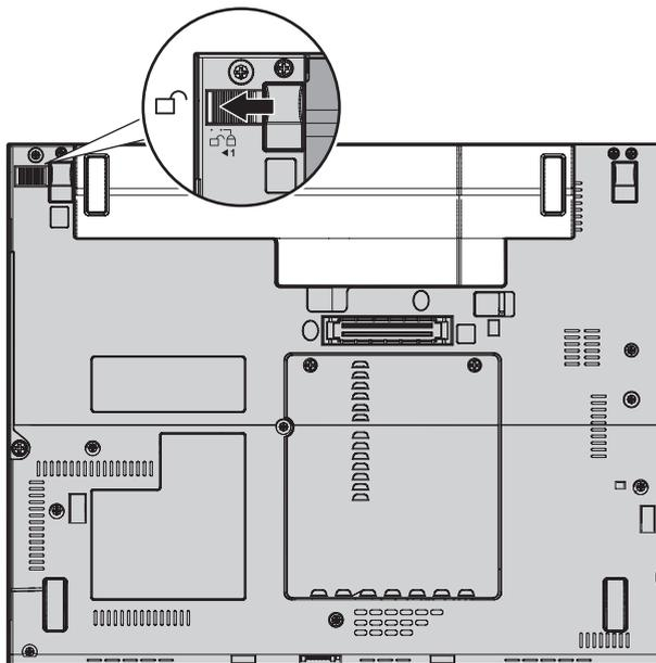
4. バッテリー・ラッチをスライドさせて固定し **1**、バッテリーを取り外します **2**。
