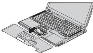
**8** Se um SO-DIMM já estiver instalado, remova-o conforme mostrado. Guarde o SO-DIMM para uso futuro.
