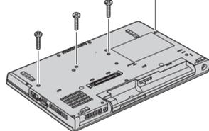
**7** Vire o computador novamente e remova o apoio de mão. Não é necessário desconectar o cabo do trackpad.
