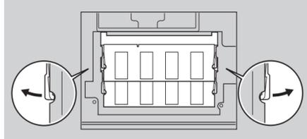
**9** Alinhe a fenda na extremidade do contato do SO-DIMM com o divisor no soquete. Insira o SO-DIMM no soquete em um ângulo de 20 graus **1**, e, em seguida, gire-o até que fique firme no lugar **2**.
