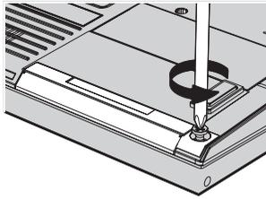
5. Abra o monitor do computador; em seguida, coloque o computador de lado e remova a unidade de disco rígido, puxando a tampa para fora do computador.
