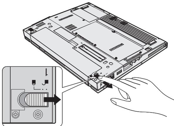
4. Deslize e segure a trava da bateria **1**; em seguida, remova a bateria **2**.
