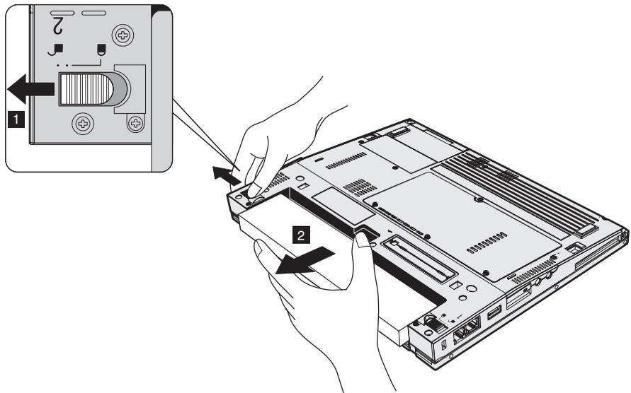
5. Alinhe a frente de uma bateria reserva completamente carregada com a parte frontal do espaço para a bateria no computador; em seguida, empurre cuidadosamente a bateria no espaço.
