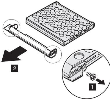
7. Coloque a tampa em uma nova unidade de disco rígido.
