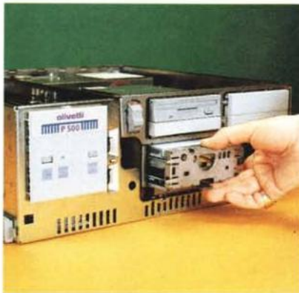
Particolare delle modalità di estrazione del winchester.
