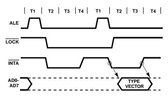
FIGURE 8. INTERRUPT ACKNOWLEDGE SEQUENCE
