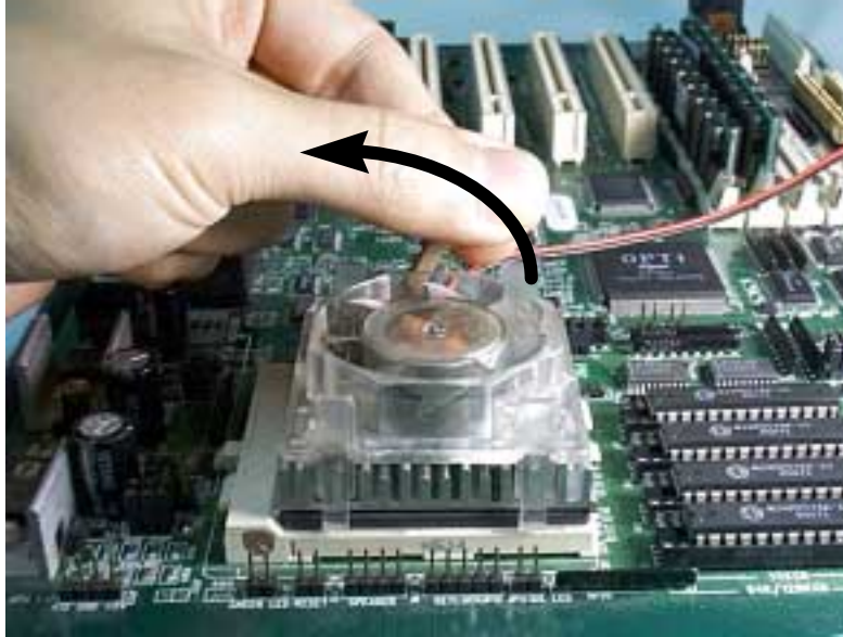
Figure 4. Raising the ZIF socket arm
