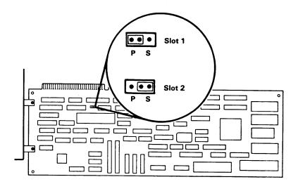
FIGURE 10. ADAPTER JUMPER
