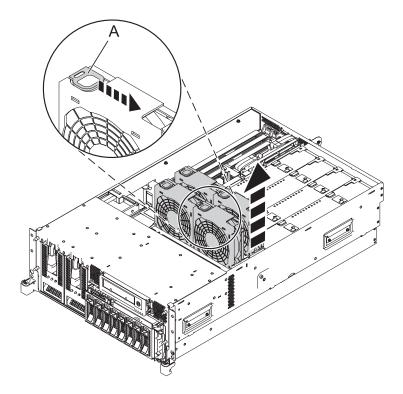
Figure 122. Removing the fan from the 8233-E8B or 8236-E8C fan cage
