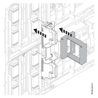
Figure 92. Using the SMP cable tool
