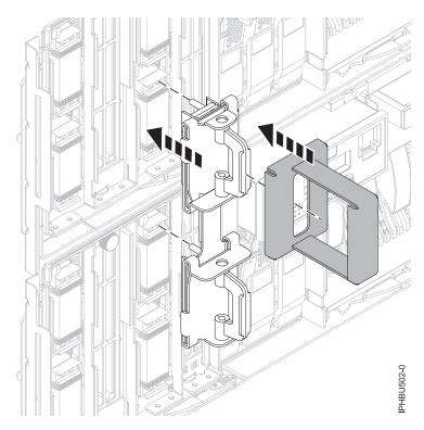
Figure 11. Using the SMP cable tool
