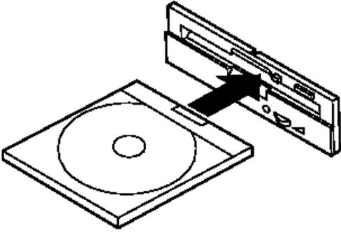
6. To eject the CD-ROM caddy, press and hold the eject button.
